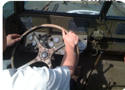
Le «DUCK» est un GMC qui va sur l'eau. 6 roues motrices sur terre et une hélice dans l'eau
