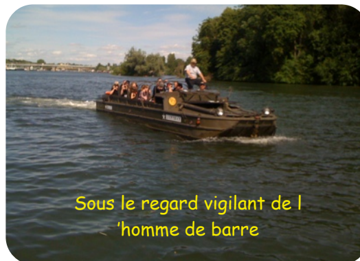
Le «DUCK» est un GMC qui va sur l'eau. 6 roues motrices sur terre et une hélice dans l'eau
